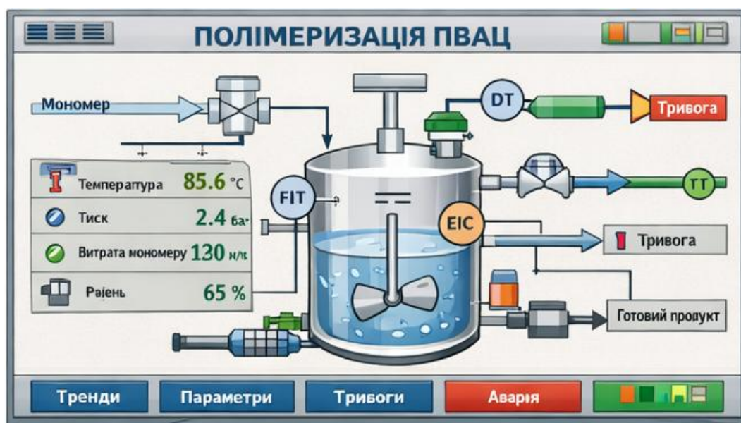
Рисунок 2.3 Схема SCADA-системи керування
