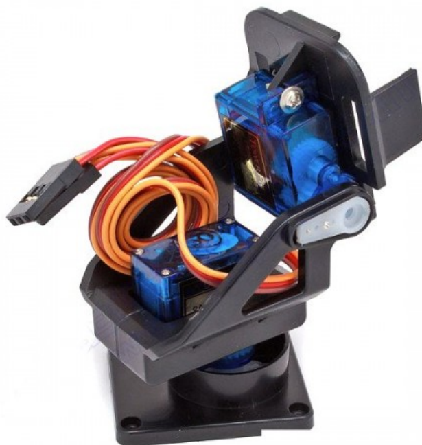
Рисунок 2.3.4 – Кронштейн для сервоприводів SG90
