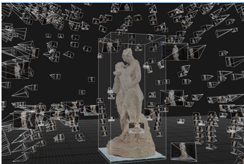
Рисунок 1.2.4 – Приклад реконструкції об'єкта методом фотограмметрії
