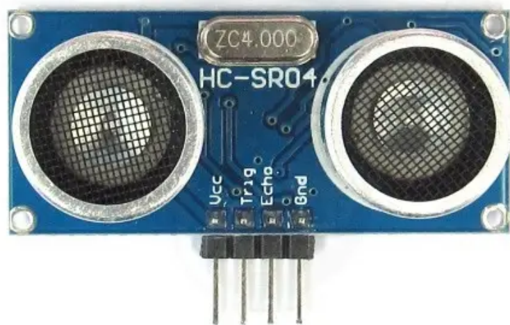
Рисунок 2.2.1 – Ультразвуковий датчик відстані HC-SR04
