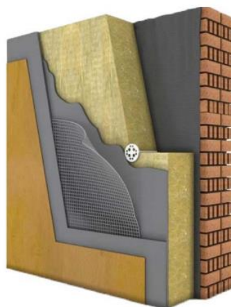
Рисунок 3.2 – Утеплення стін мінераловатними плитами
