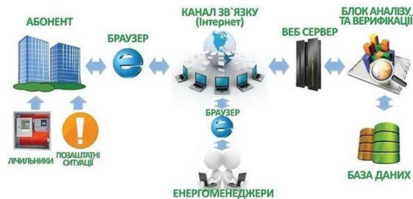
Рисунок 4.1 – Принципова схема роботи та взаємодії АСЕМ
