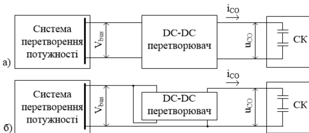
Рисунок 1.2 – Перетворювачі повної потужності (а) та часткової потужності (б)
