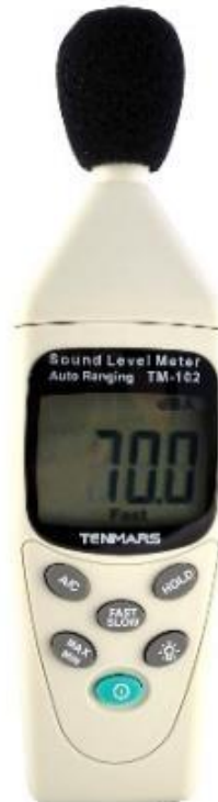
Рисунок 1.5 - Шумомір Tenmars TM-102
