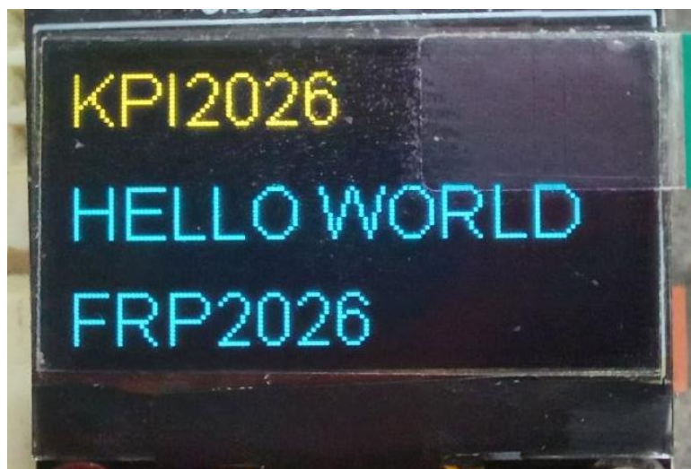
Рисунок 2.14 – Перевірка працездатності дисплею
