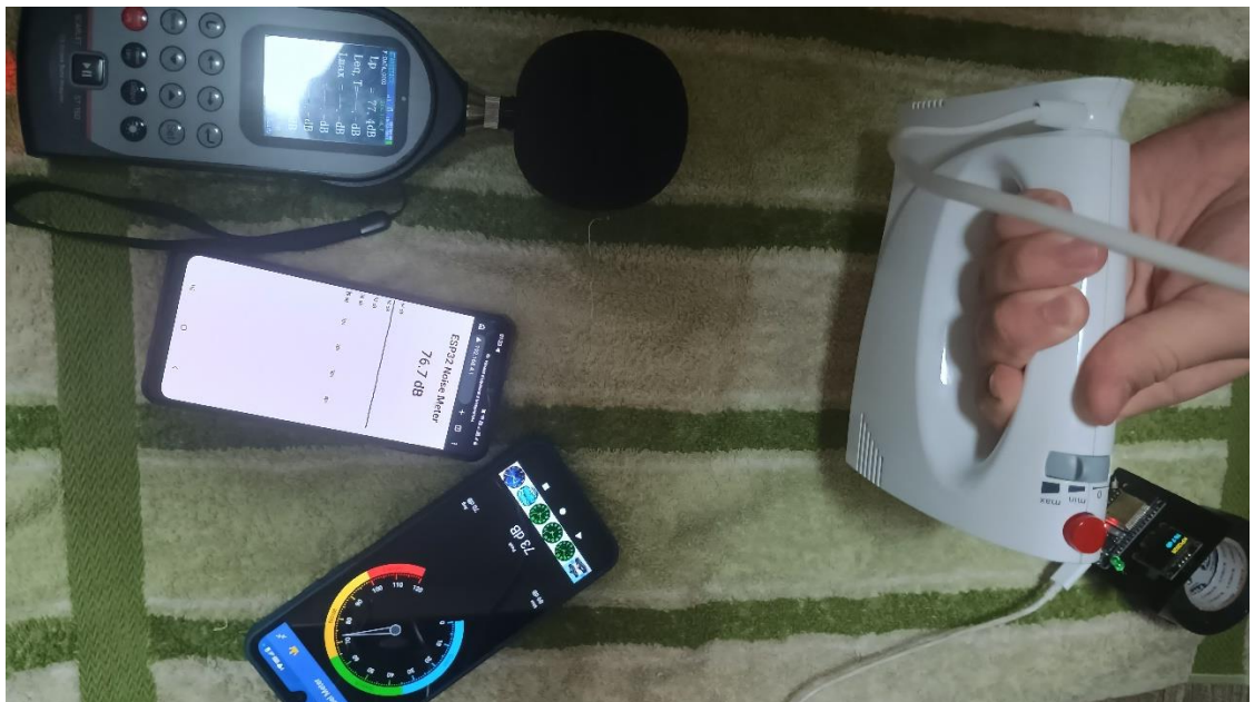
Рисунок 2.29 – Вимірювання рівня шуму, створюваного міксером Bosch Clevermixx
