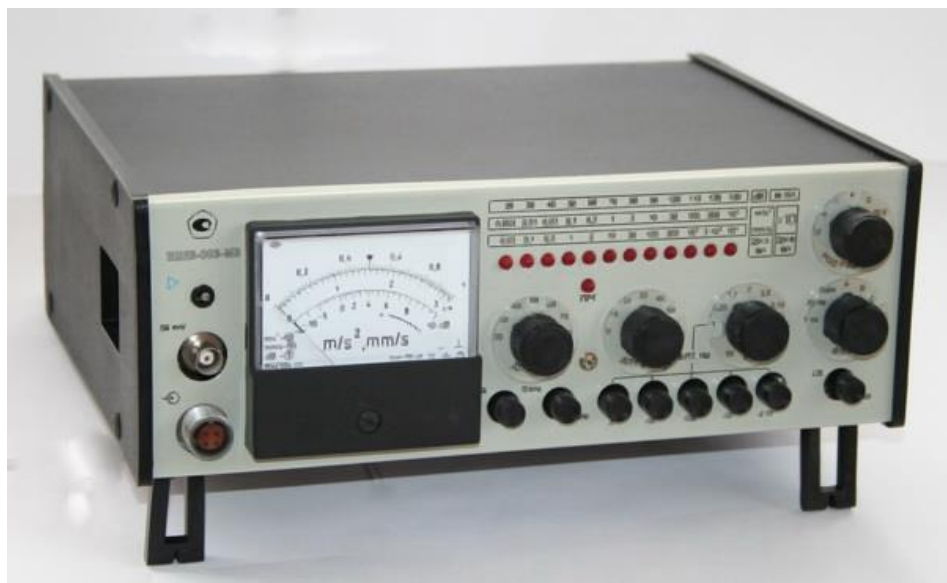
Рисунок 1.3 – Електромеханічний шумомір ВШВ-003-М2
