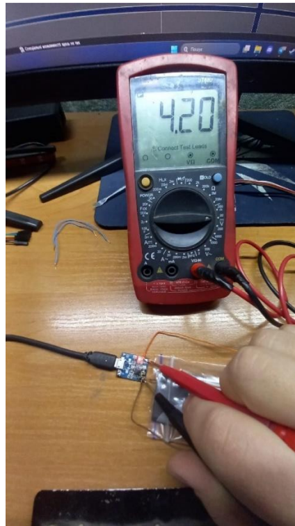
Рисунок 2.18 - Перевірка процесу заряджання батареї
