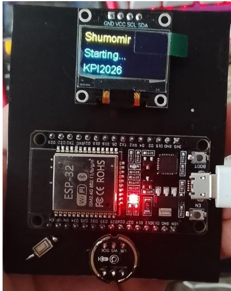
Рисунок 2.26 – Виготовлений пристрій на друкованій платі
