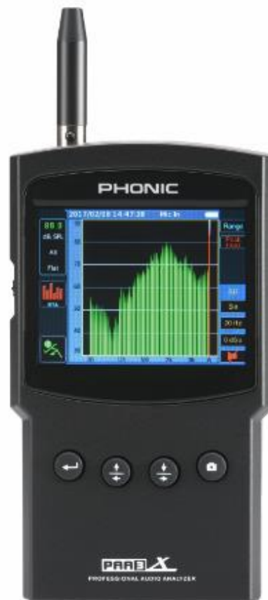
Рисунок 1.6 - Спектральний аналізатор Phonic PAA 3X
