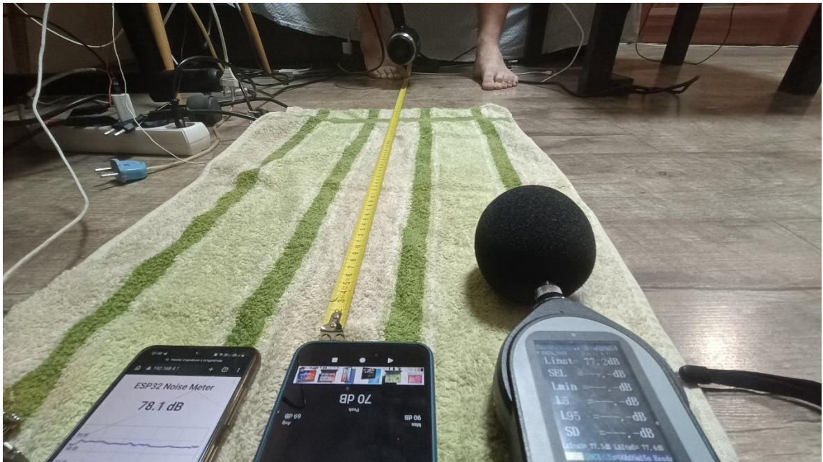
Рисунок 2.31 – Вимірювання рівня шуму, створюваного феном ARDESTO Violet Pro на дистанції в 1 м.
