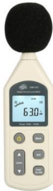
Рисунок 1.4 – Цифровий шумомір BENETECH GM1357
