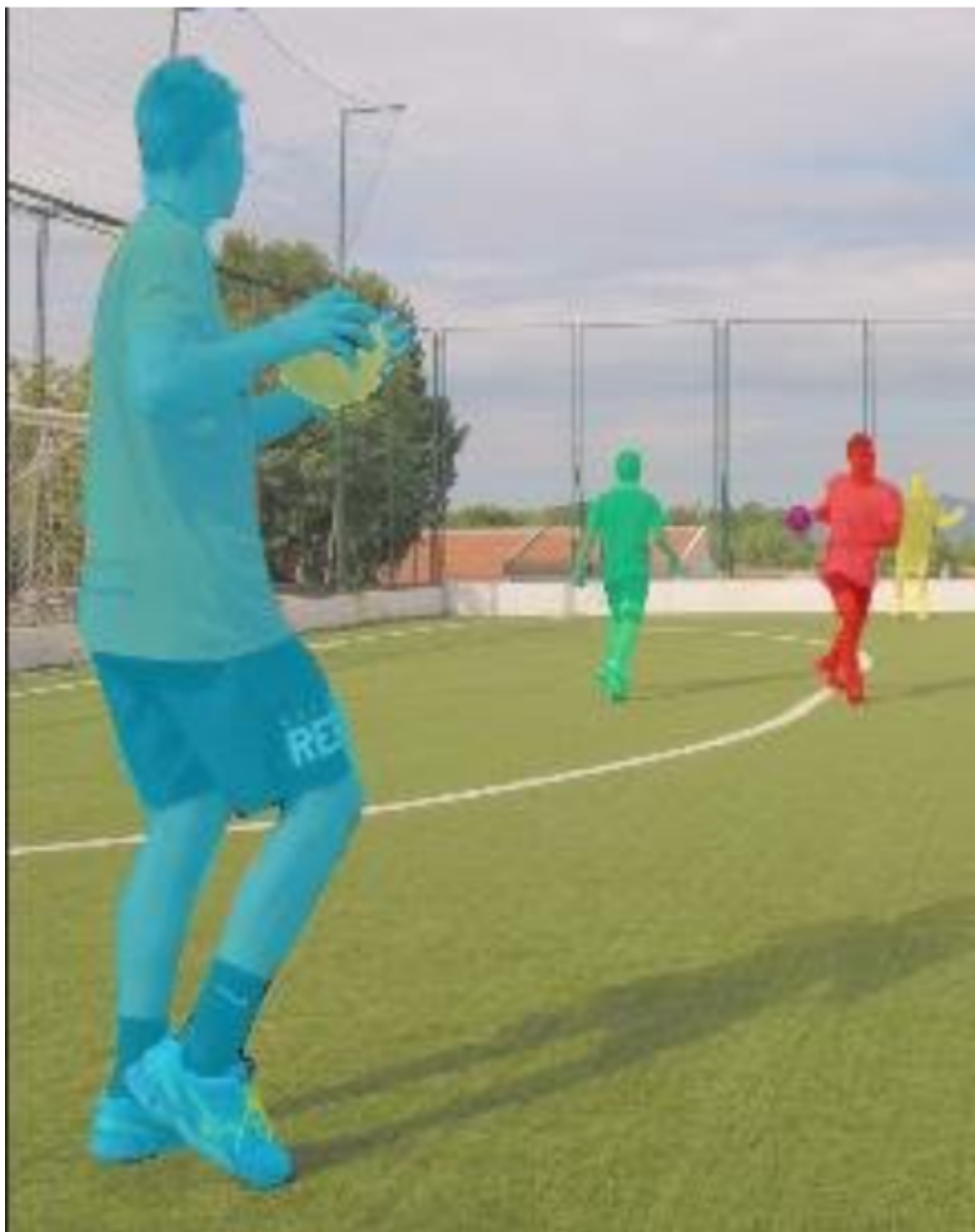
Рисунок 2.7 – Розпізнавання людини з використанням Mask R-CNN.
