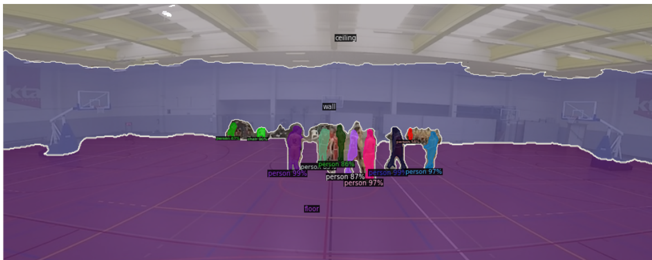
Рисунок 2.5 – Модель COCO Panoptic Segmentation.
