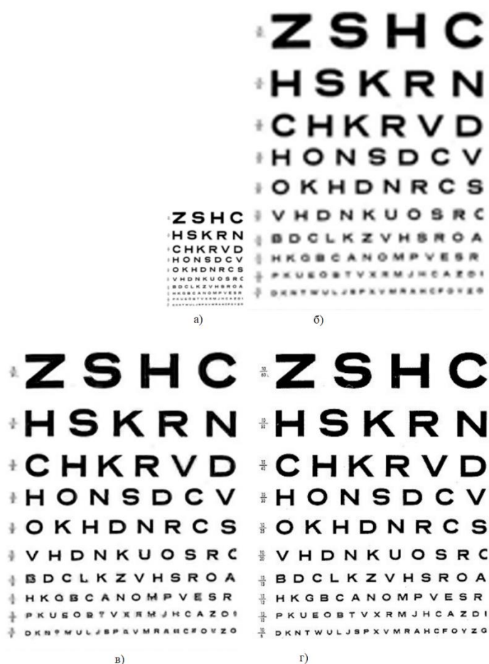
Рисунок 4.2 – Візуальне порівняння оригінального зображення та зображень зі збільшеною роздільною здатністю: а) оригінал; б) збільшення роздільної здатності за допомогою бікубічної інтерполяції; в) збільшення роздільної здатності за допомогою алгоритму SRSI; г) справжнє зображення оригіналу з більшою роздільною здатністю
