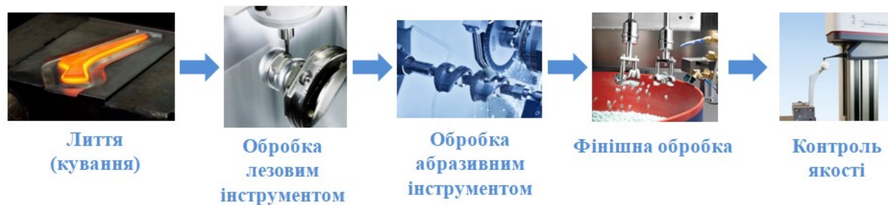
Рис. 2.1 – Основний процес виготовлення імплантатів [13, 14, 15 ,16]
