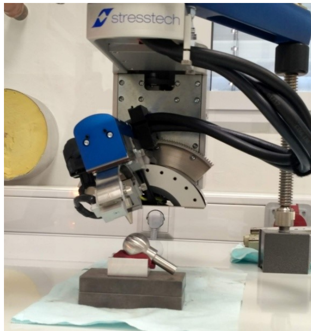
Рис. 2.6 – Вимірювання внутрішніх напружень на приладі Xstress D45
