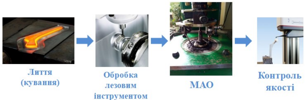
Рис. 2.2 – Альтернативний процес виготовлення імплантатів [13, 16, 17]
