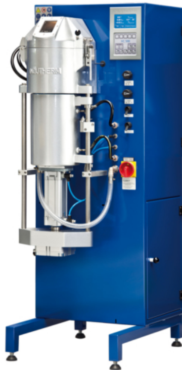
Рисунок 3.3 – Індукційна ливарна вакуумна машина Indutherm VC500
