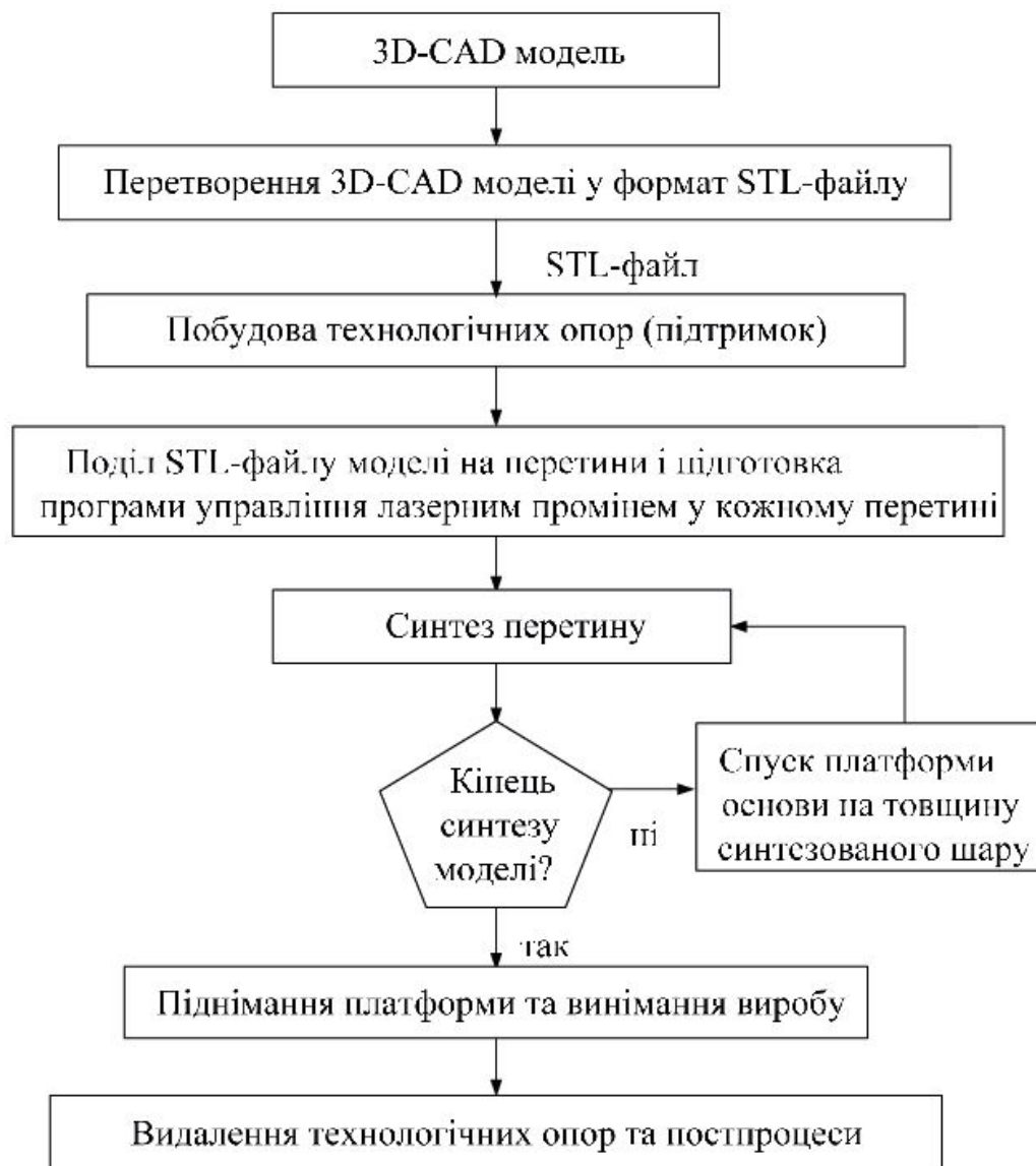
Рис. 2 – Схема керуючої програми обробки STL файлу
