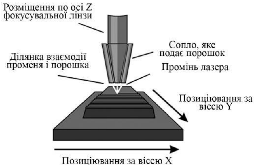
Рис. 9 – Схематичне зображення LENS способу
