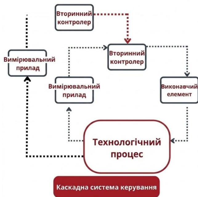
Рисунок 1.8 – Схема системи автоматичного регулювання (контур керування)
