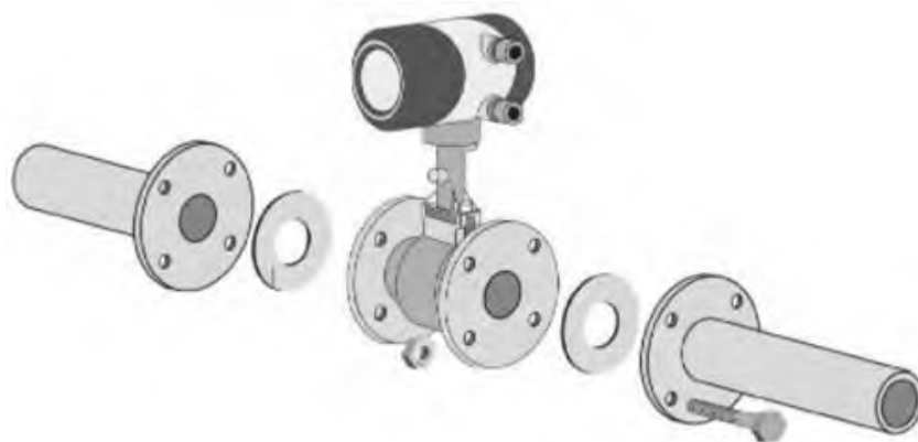
Рисунок 2.6 – Фланцевий монтаж витратомірів (давач «врізається» в трубу)
