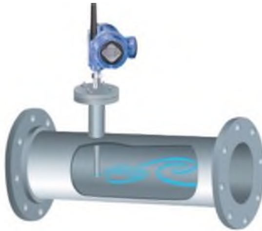
Рисунок 2.3 – Фланцевий монтаж датчиків температури в трубу
