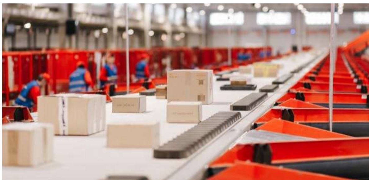
Рисунок 2.10. Сортувальна система за типом «shoe sorter» із спеціальними колодками скидання Джерело: [37]
