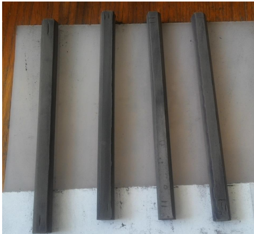
Рисунок 2.4 – Спресовані довгомірні заготовки кераміки B_4C
