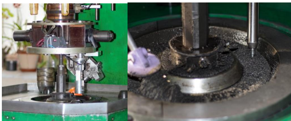
Рисунок 2.2 – Процес MAO твердосплавних пластин
