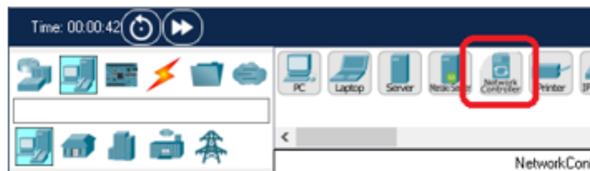
Рисунок 5 – Вибір пристрою Network Controller
