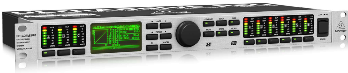
Рисунок 2.1 — Існуючі DSP-процесори: а — Dayton Audio DSP-408; б — Behringer DCX2496
