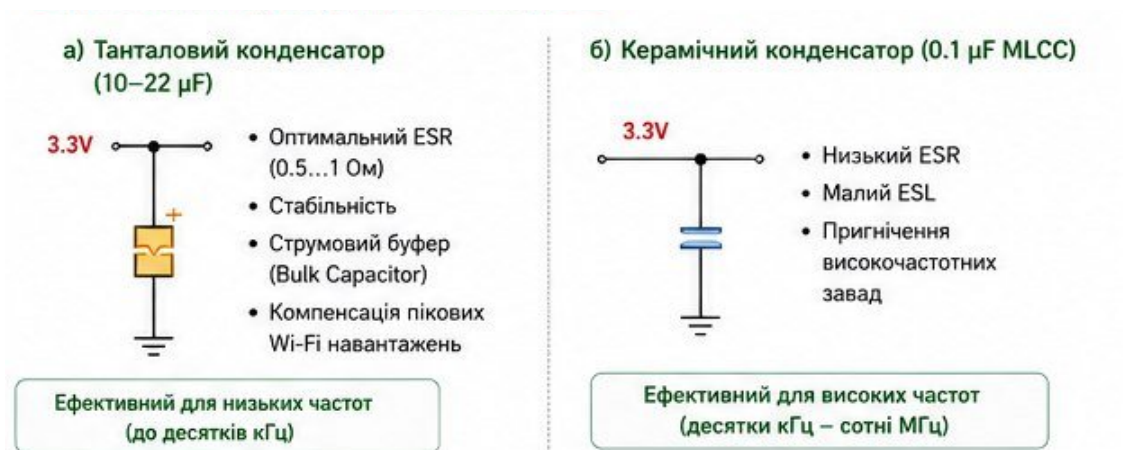
Рисунок 4.4 - Комбінована фільтрація на вході LDO
