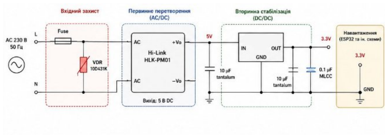
Рисунок 4.1 - Загальна електрична схема підсистеми енергозабезпечення
