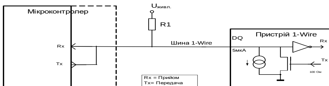
Рисунок 4.11 – Схема апаратної реалізації інтерфейсу 1-Wire
