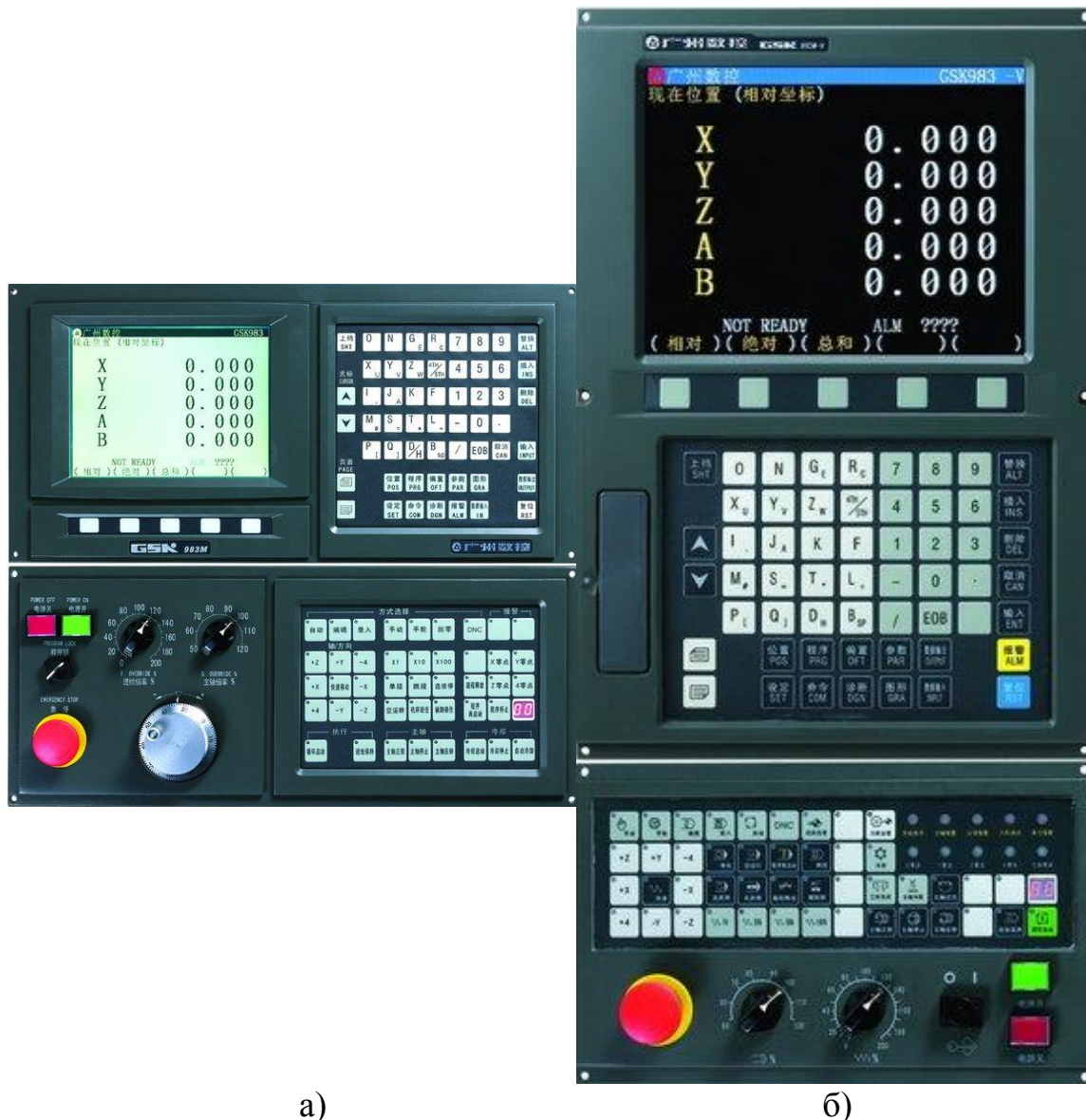
Рис. 55. Системи ЧПК: а) GSK 983M-S (стандартное исполнение); б) GSK 983M-V (расширенное исполнение)
