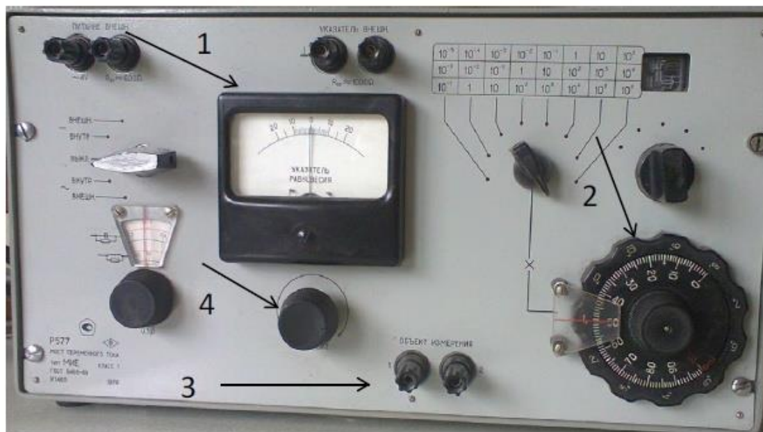
1 – показчик рівноваги мосту, 2 – лімби ступінчастого і плавного регулювання опорів пліч моста при його врівноваженні, 3 – вхідні клєми, 4 – потенціометр для регулювання чутливості.
