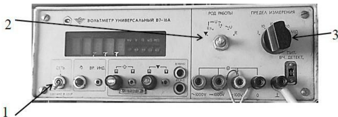
1 – тумблер для вмикаання приладу; 2– перемикач роду роботи (вимірювання напруги або опору); 3 – перемикач межі вимірювання
