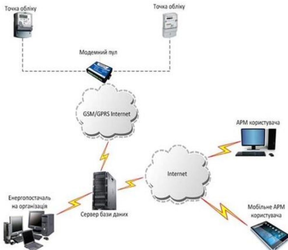
Рисунок 4.1 – Схема підключення АСОЕ
