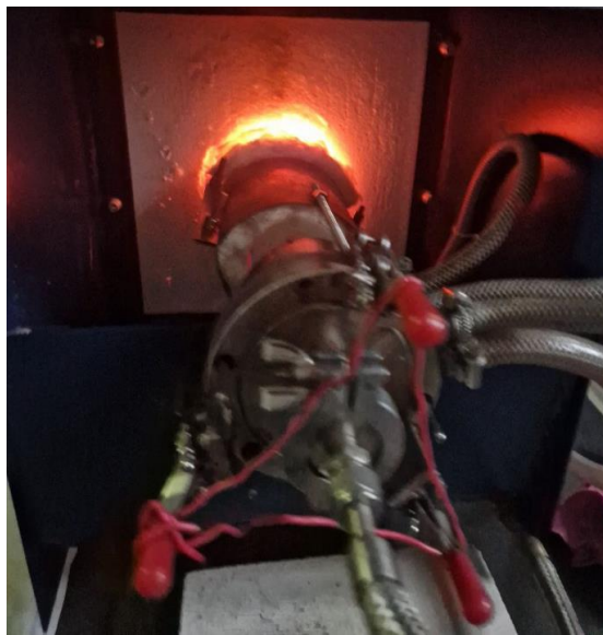
Рисунок 2.2 – Зовнішній вигляд печі при температурі ізотермічної витримки
