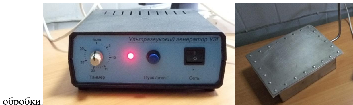
Рис. 4.2. - Світлина ультразвукової установки: а – ультразвуковий генератор, б – ультразвуковий перетворювач 2 (погружний блок)
