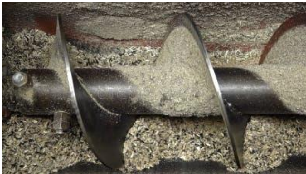
Рис. 4.5 - Процес подрібнення насіння соняшнику для вилучення олії.
