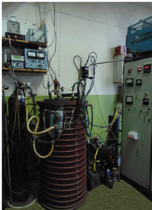
Рисунок 1. Загальний вигляд установки йонно-плазмового термоциклічного азотування
