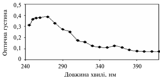
Рис. 1. Залежність оптичної густини від довжини хвилі для системи Fe (III)-CF-10
