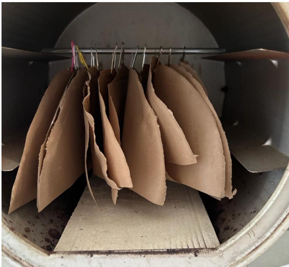
Рисунок 3.3 – Візуалізація процесу штучного старіння у шафі за температури 105 °C
