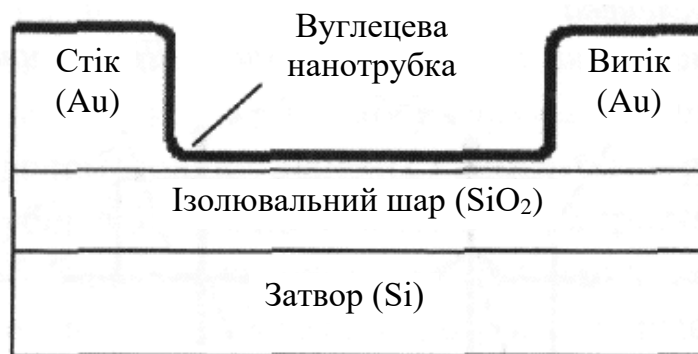
Рис. 9.24. Схема польового транзистора на основі вуглецевої нанотрубки
