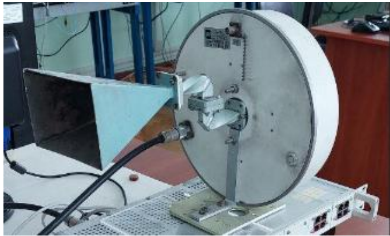
Рис. 4.3 Надійне закріплення антени на пластині
