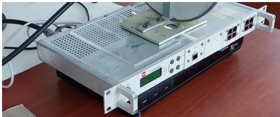
Рис. 4.4 Встановлення та підключення модемного обладнання
