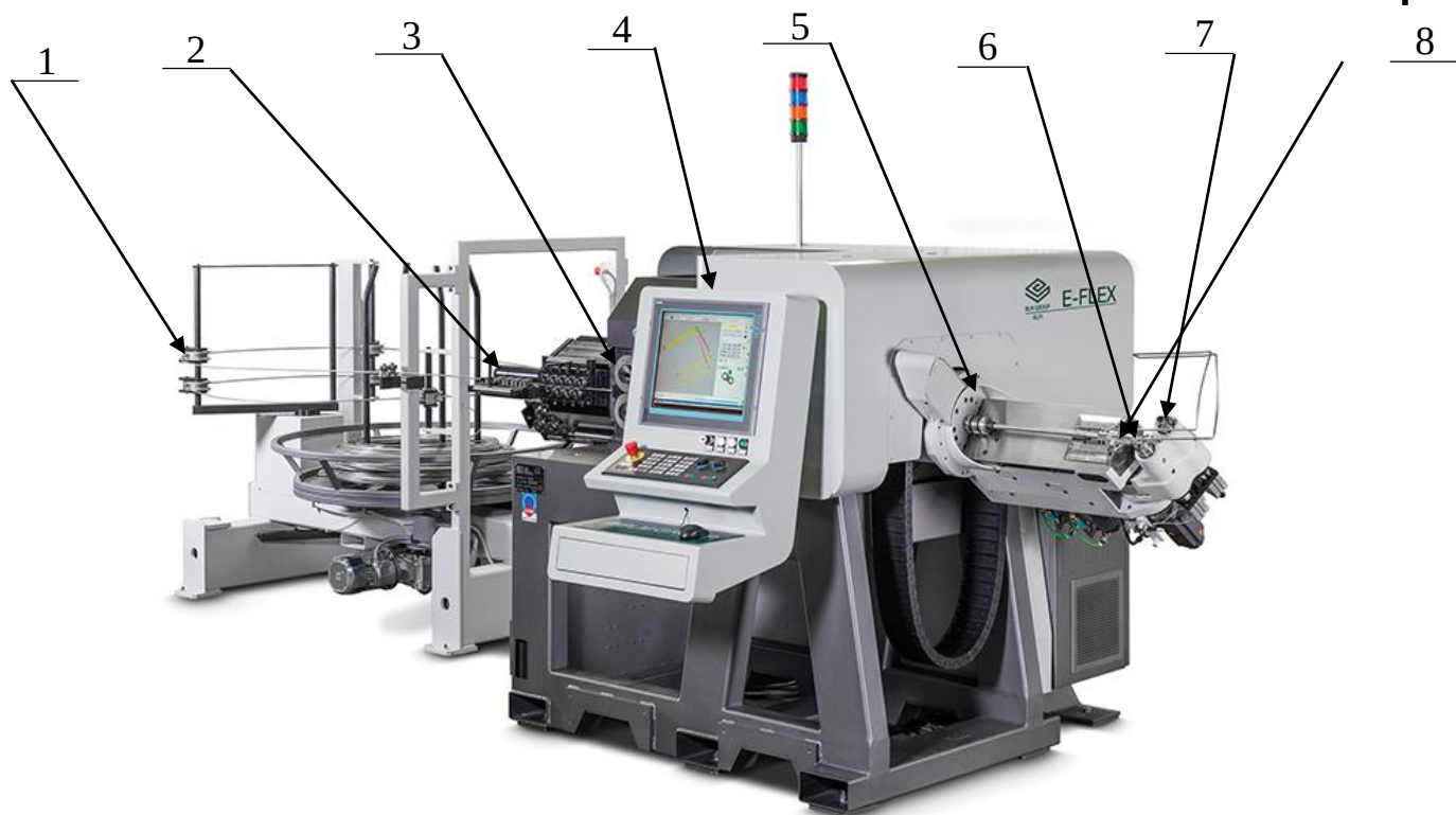
Рис1.7 Верстат 582BM EVV E-FLEX [11] ( 1 – система переднатягу, 2 – система вирівнювання, 3 – система подачі, 4 – екран, 5 – механізм обертання, 6 – головка згинальна перша, 7 – головка згинання друга, 8 – система відрізання)
