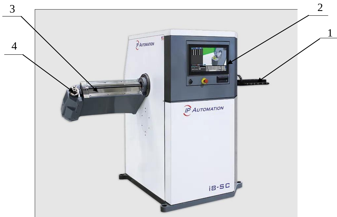
Рис1.6 Верстат для гнуття IP Automation i8-SC [10] (1 – система вирівнювання, 2 – екран програмування, 3 – станина, 4 – система відрізання)
