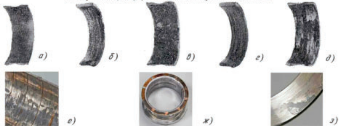
Рис.5 - Зношування та пошкодження вкладишів ПКз (по працям проф. Костецького Б.І.): а) - механохімічне, б) - корозія, в) - схоплюваність, г) - абразивне, д) - відшаровування; та фотографії зруйнованих ПКз, знайдені в інтернеті без підпису підписів - е), ж), з)
