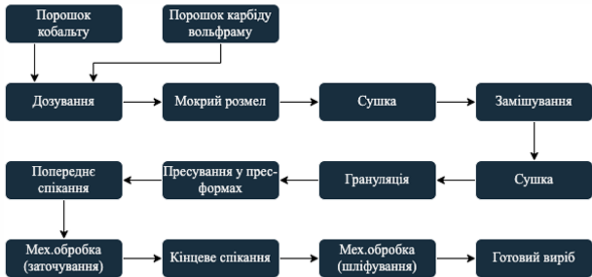
Рисунок 1.5 – Схема технологічного процесу виготовлення твердосплавних виробів холодного пресування з двостадійним спіканням
