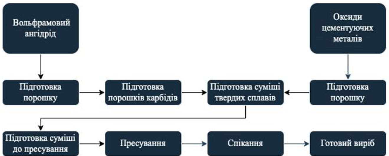
Рисунок 1.1 – Узагальнена послідовність технологічних операцій виготовлення вольфрамовмісного твердосплавного інструменту [12]
