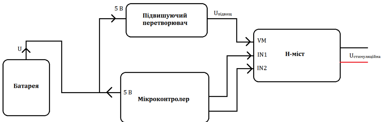
Рисунок 3.1 Блок схема стимулятора
