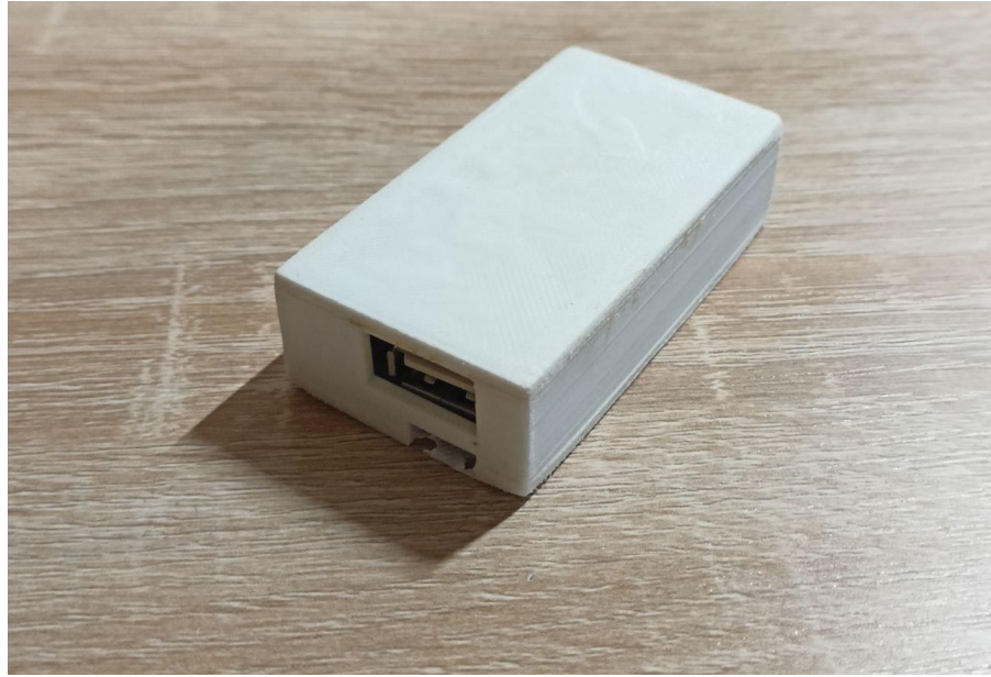
Рисунок 3.36 - Надрукована модель корпусу для модуля акумулятора
