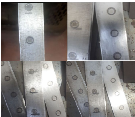
Рис. 3.24 – Зварні точкові з'єднання виготовлені з допомогою експериментальних електродів
