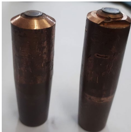
Рис. 4.26 – Електроди після зварювання
