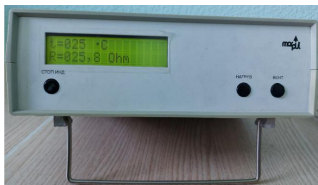
Рис. 4.1. Прилади для дослідження залежності опору від температури: пічка з нагрівальним елементом і датчиком (справа) і блок управління (зліва)
