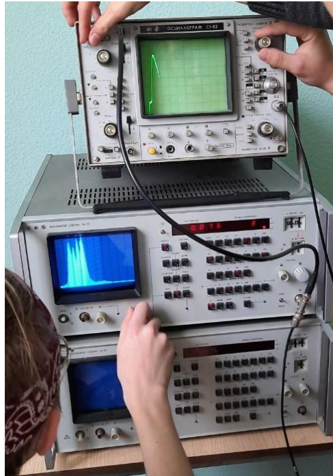
Рис. 1.3. Аналізатор спектра С4-77 (знизу) і осцилограф СІ-82 (зверху)
