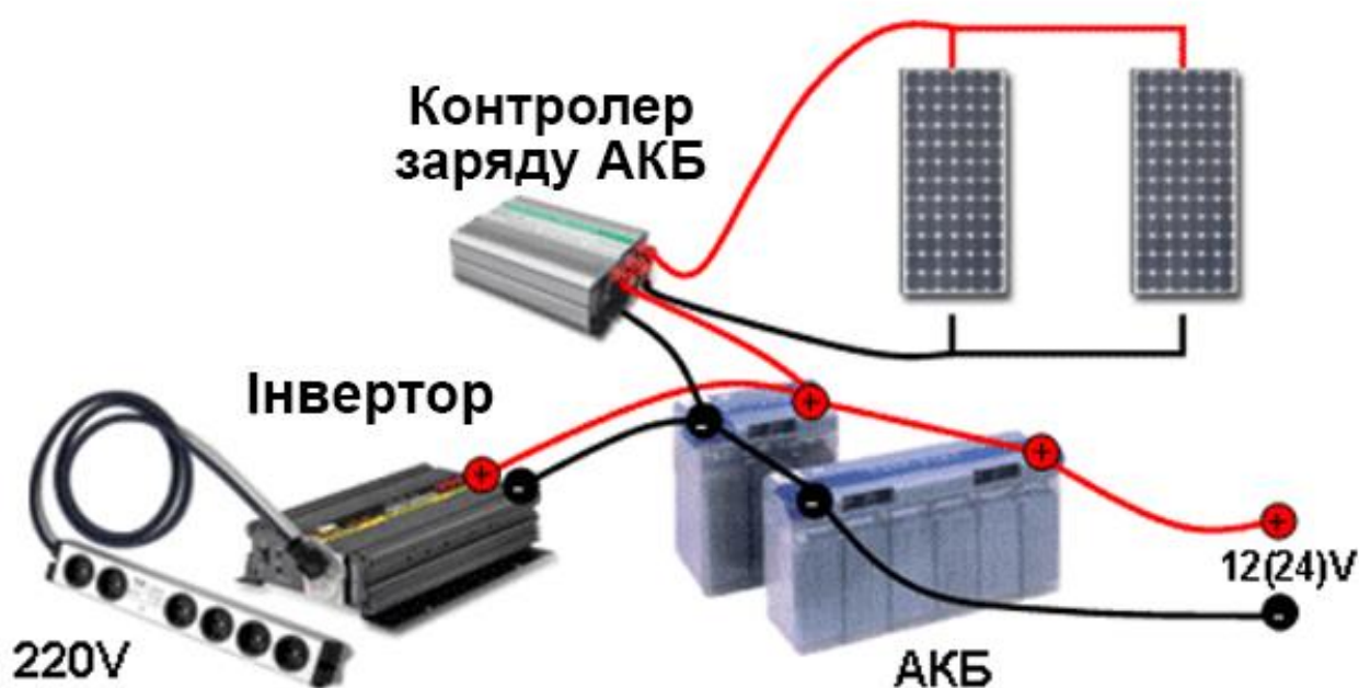
Рисунок 4.7 — Схема сонячної мікроенергостанції
