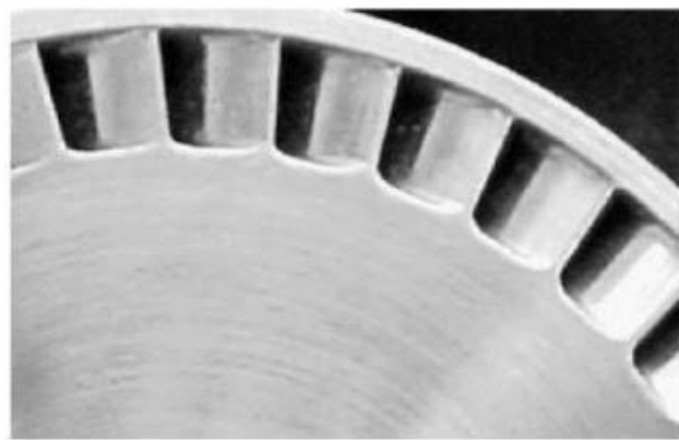
Рисунок 1.8 – Моноколесо із міжлопаточними каналами, отриманими методом ЕЕО.
