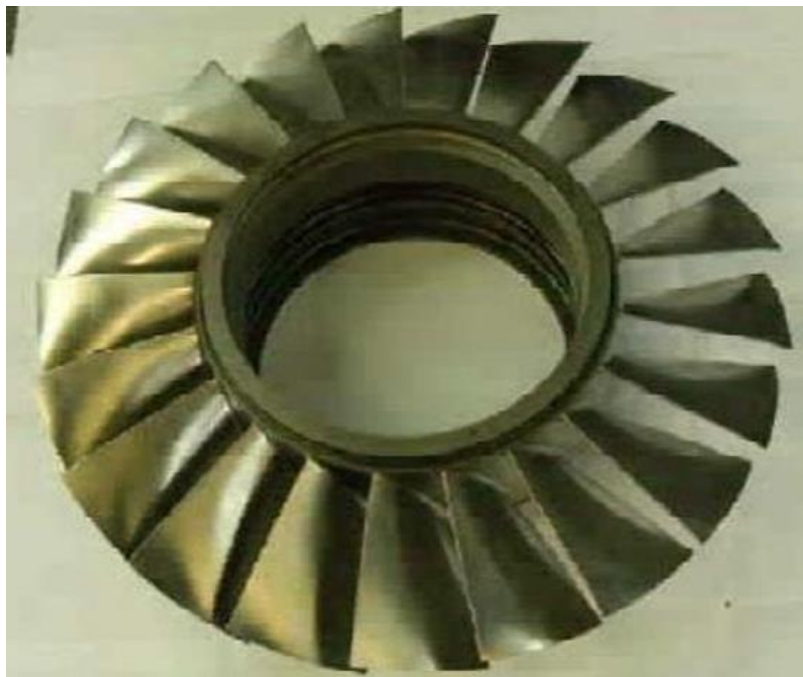
Рисунок 1.11 – Осьове моноколесо, яке виготовлене високошвидкісним фрезеруванням.
