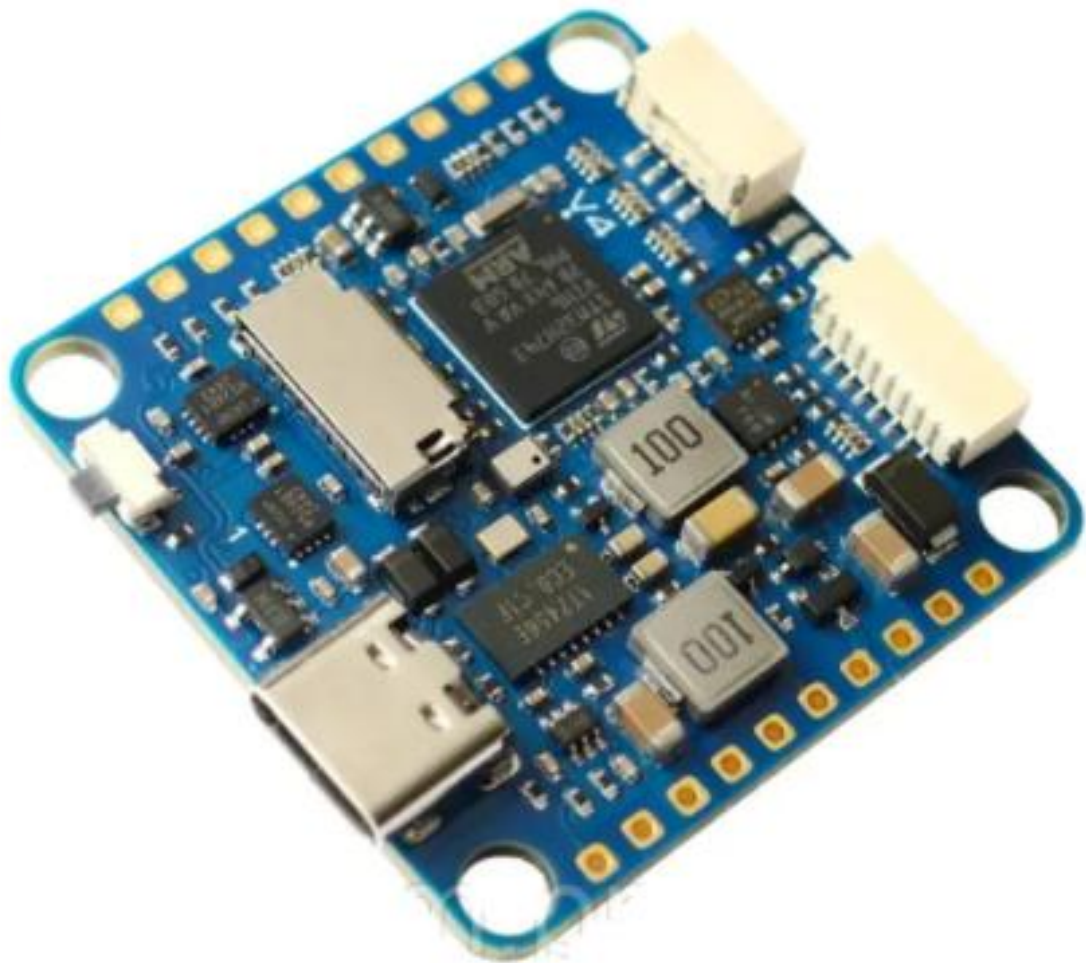
Рисунок 2.3 — Політний контролер Matek H743-SLIM-V4
