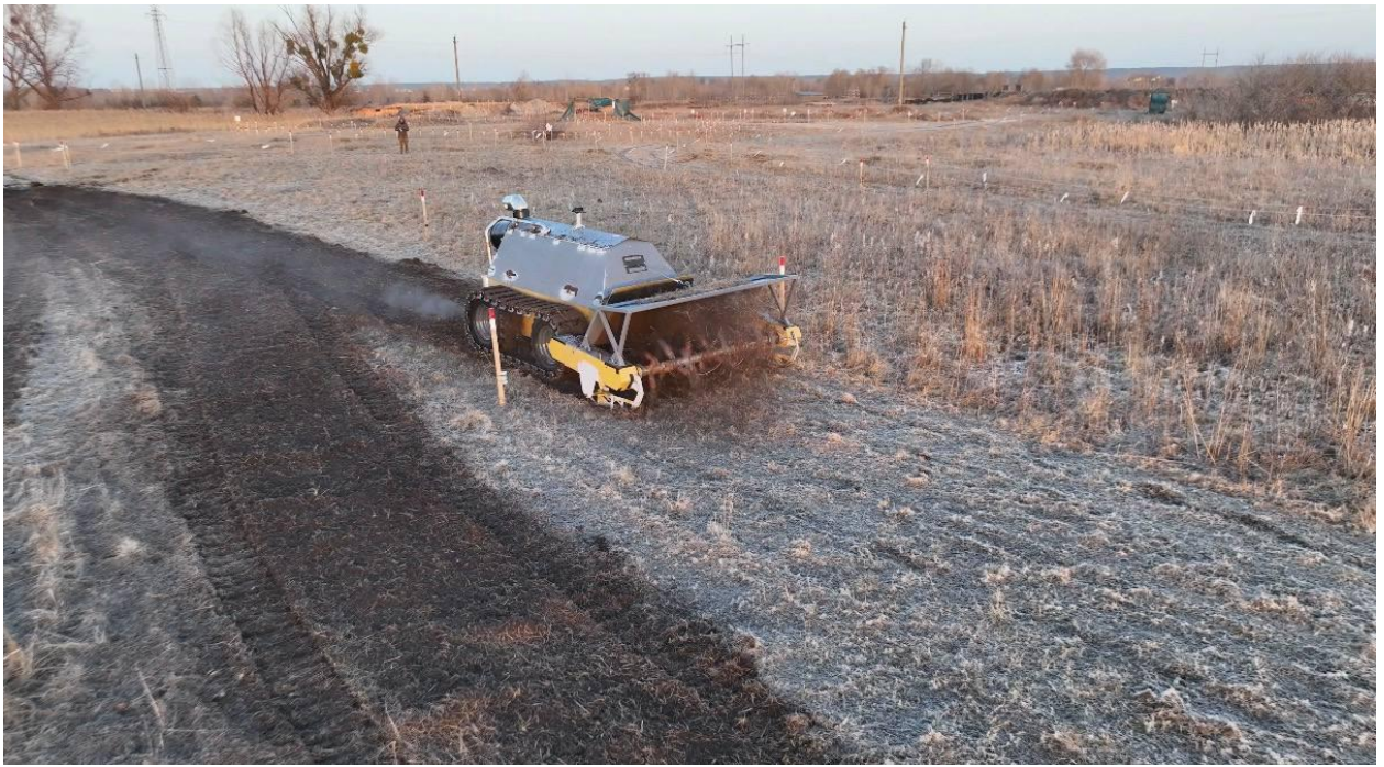
Рисунок 5.2 — Безпілотна платформа для розмінування з встановленим модулем керування
