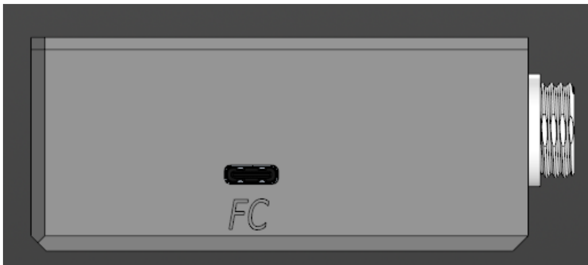
Рисунок 4.3 — Бічна панель корпусу з роз'ємом USB Type-C
