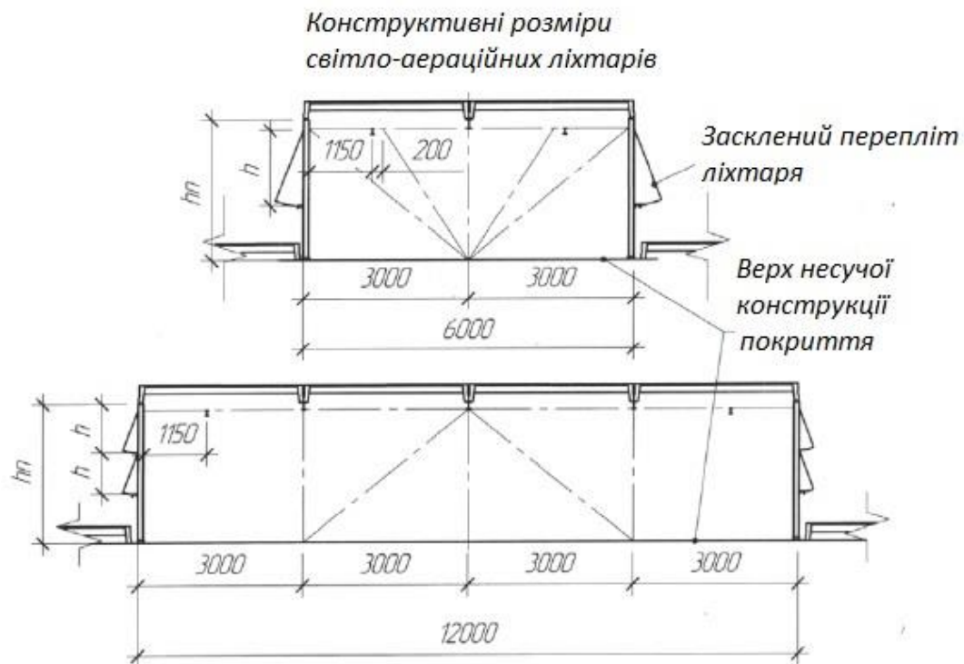
Рис. 3.13. Конструкції світло-аераційних ліхтарів
