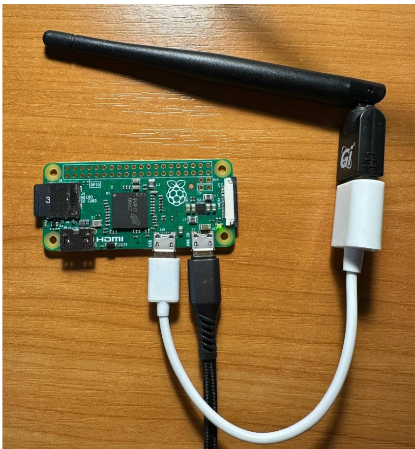
Рисунок 2.1 – Фізичне підключення Raspberry Pi Zero V1.3
