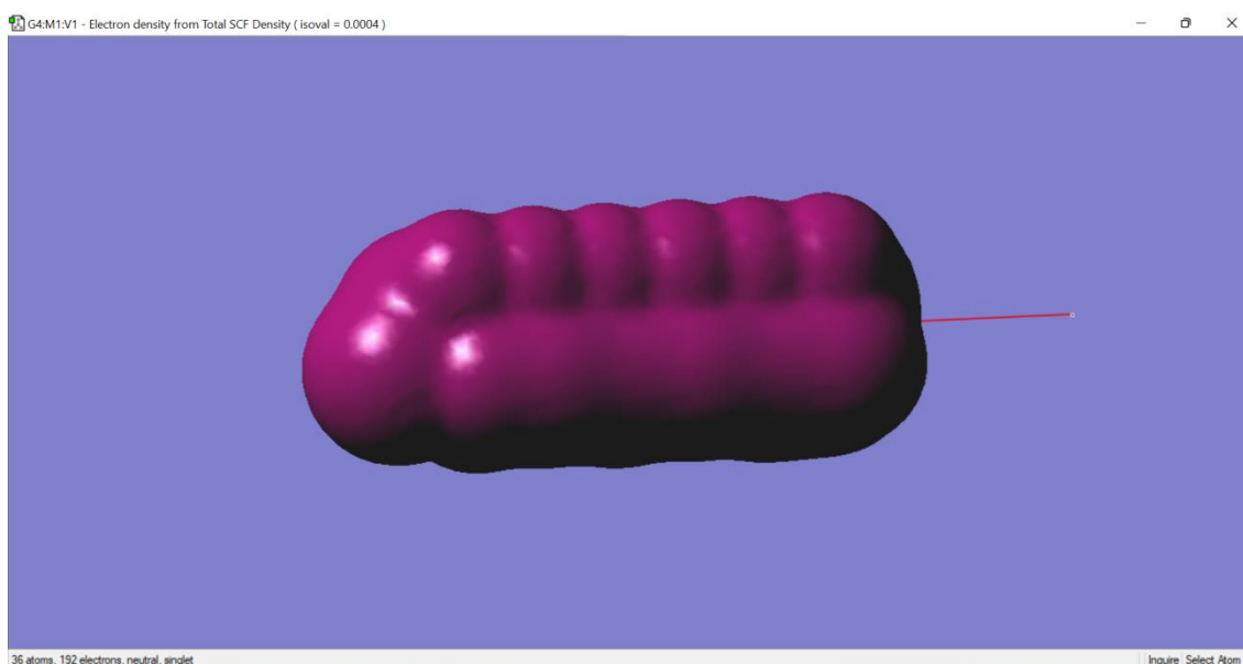
Рис. 2.20 Поверхня щільності електронів для не оптимізованого полімера ПВДФ
