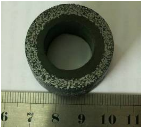
Рис. 4. Загальний вигляд зразків, отриманих відцентровим ущільненням
