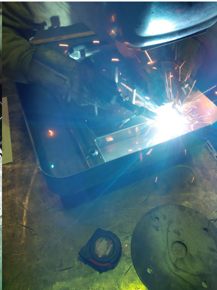
Рисунок 3.7 – Виготовлення підіуму стаціонарного та підіуму обертання
