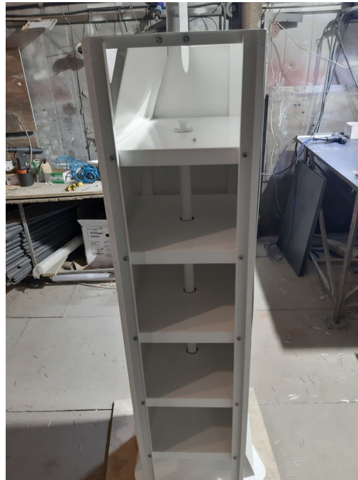
Рисунок 3.10 – Прототип силової конструкції модуля складської системи з інтерактивним модулем
