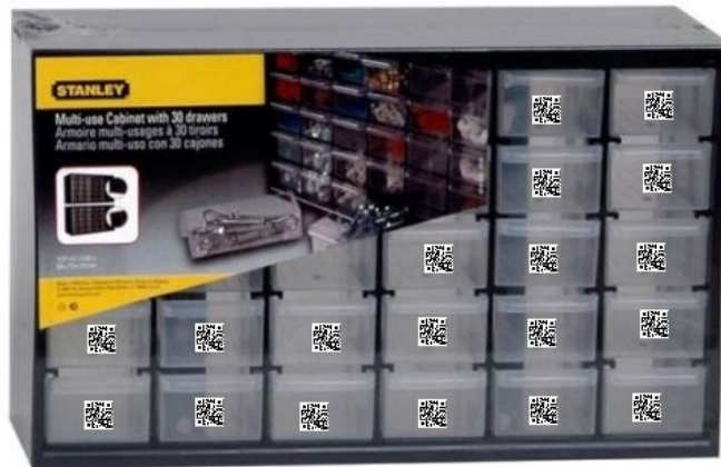
Рисунок 1.7 – Маркування кейсів для інструменту[6]
