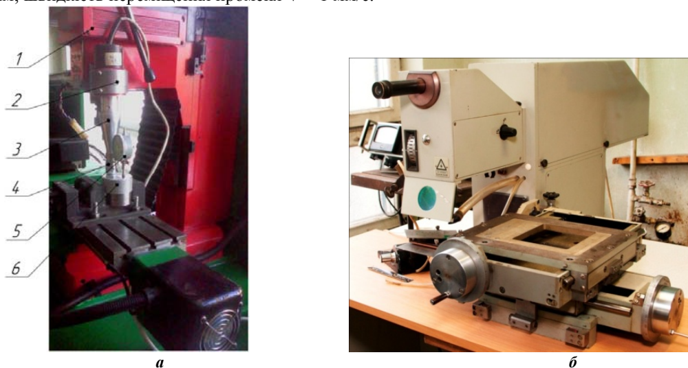
Рис. 2. Технологічне обладнання: а-стенд для УЗО (1-верстат з ЧПК марки «DYNAMITE 2800», 2-спеціальний пристрій, 3-ультразвуковий інструмент, 4-багатобічковий наконечник, 5-індикатор, 6-заготовка); б-лазерна установка «Квант15»
