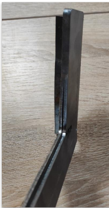
Рисунок 3.7 – Фото бракованого листового матеріалу
