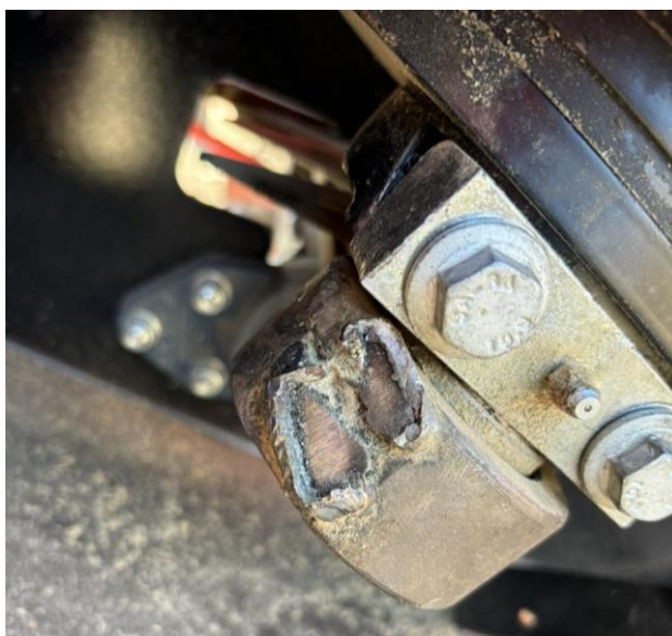
Рисунок 3.2 – Фото обірваної головки різальної коси, зроблене клієнтом
