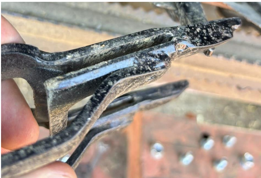
Рисунок 3.3 – Фото слідів затирання різальних пальців, зроблене клієнтом
