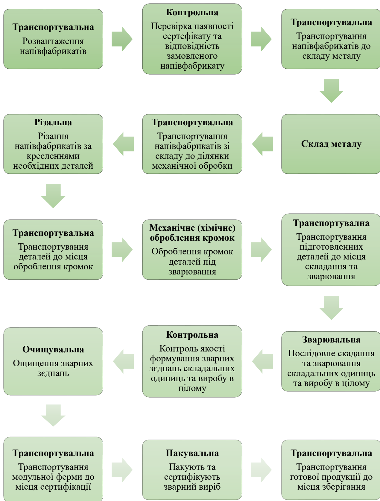
Рисунок 11 – Загальна маршрутна технологічна блок схема операцій виготовлення модульної ферми
