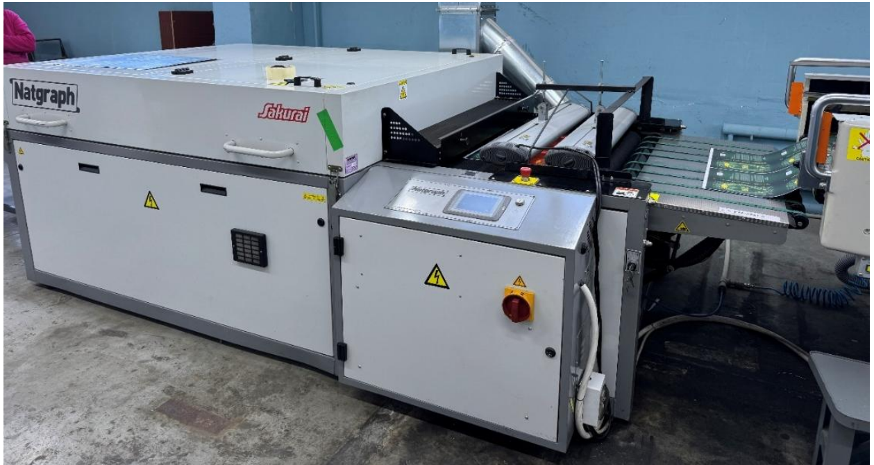
Рисунок 2.8 - УФ-сушка з двома ртутними лампами потужністю 6 кВт кожна
