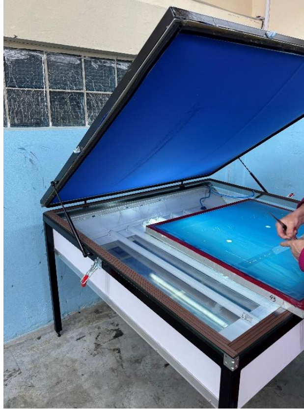
Рисунок 2.3 - Експозиційна камера для засвічування трафарету
