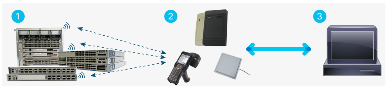
Рисунок 2.12 — Архітектура системи RFID
