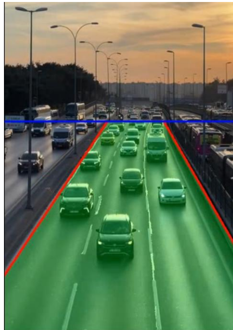
Рисунок 2.5 – Полігон дорожнього полотна.
