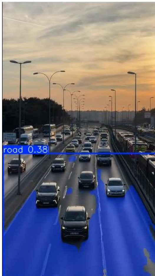
Рисунок 2.6 – Приклад роботи сегментаційної моделі виявлення дорожнього покриття.
