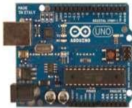
Рисунок 2.1 – Мікроконтролер Arduino Uno R3 [18]
