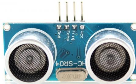
Рисунок 2.2 – Ультразвуковий датчик відстані HC-SR04 [19]
