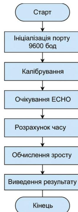
Рисунок 2.5 – Блок-схему розробленого алгоритму
